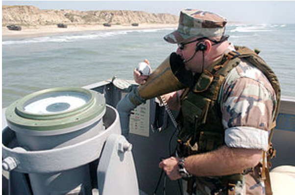
Kommunikation per Sprachrohr auf einem Schiff
